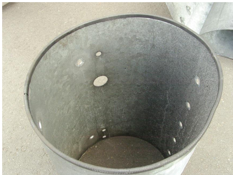
Rohr 500 beschädigt / plastisch verformt
