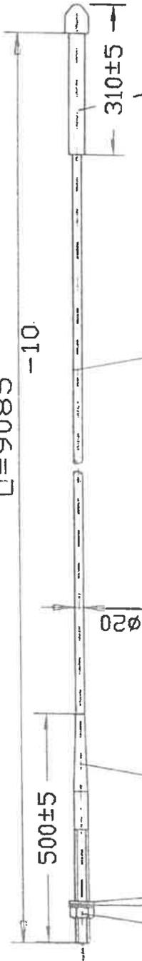
Selverpressung  $\geq \varnothing 38$  mit Kopf  $\varnothing 48,3$
